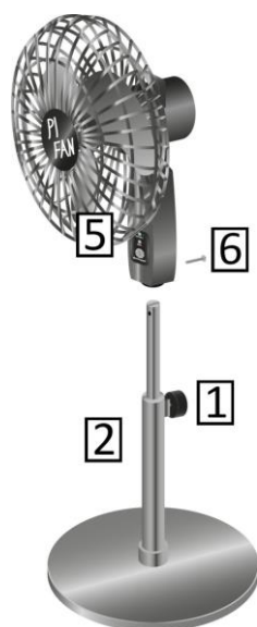
Abbildung 6: Teleskopstange mit Funktionseinheit verbinden
